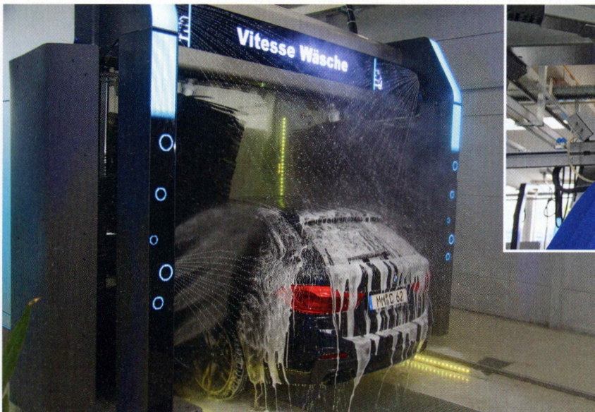
Die neue Christ-Portalwaschanlage VEGA im Einsatz: Beleuchtete Blades und Radführungsrohre sorgen für ein optisches Erlebnis während der Fahrzeugwäsche
