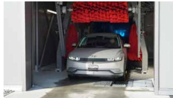
Eine Dachwalze und zwei Seitenwalzen sorgen für gute Nachtrocknung.
