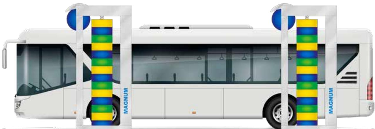
Technische Ausführung mit und ohne Dachbürste möglich
